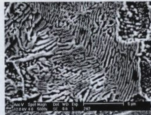
Gambar 11. Struktur mikro Baja, dengan perlakuan single normalizing 775°C, dengan Mn 0,8% Rata-rata kekerasan 93,4 HRB
