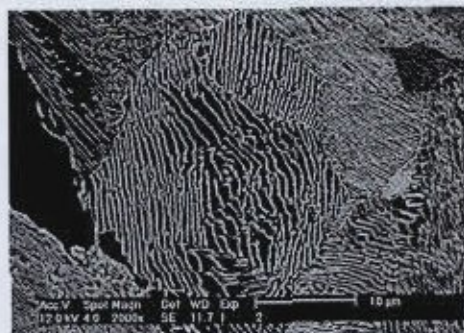
Gambar 5. Struktur mikro Baja As cast dengan Mn 0,8%, Rata-rata kekerasan 98,1 HRB
